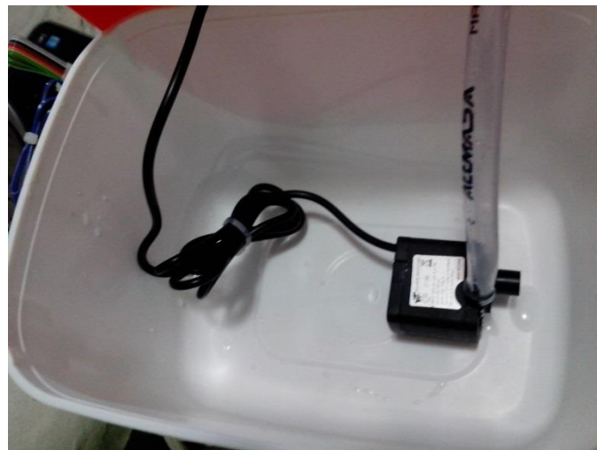
Figura 32 - Bomba d'água posicionada e mangueira direcionada para cima.
