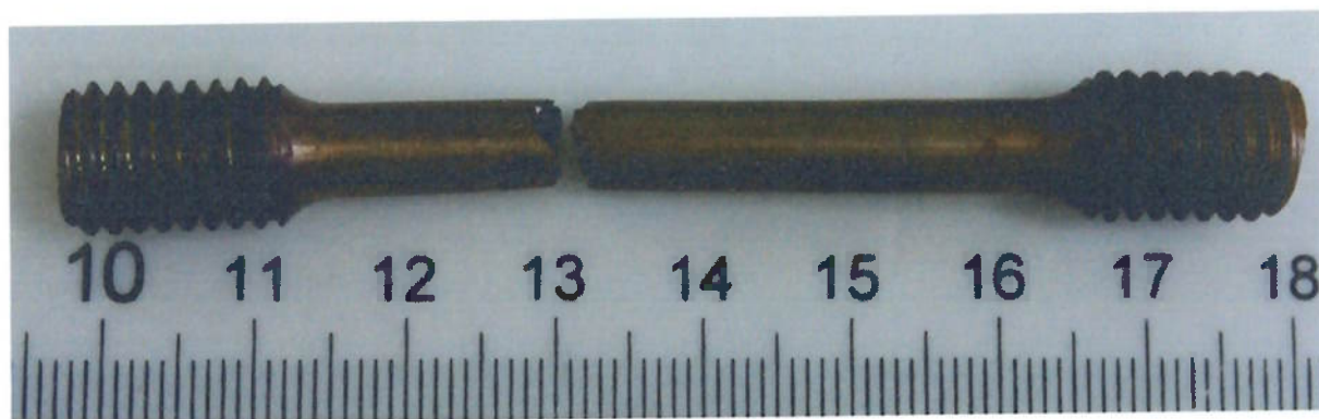
Figura 41: Amostra do ensaio de tração à quente do CP5
