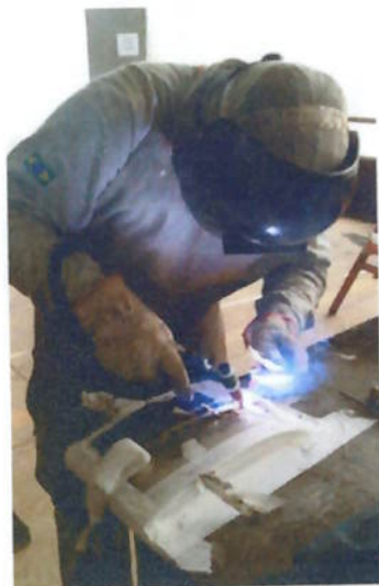
Figura 24: Soldador soldando os corpos de prova
