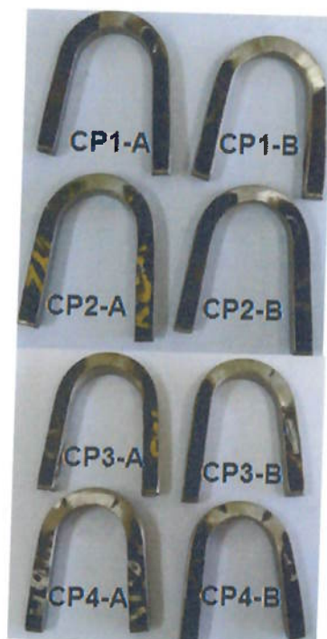
Figura 39: Registro fotográfico da amostra após ensaio de dobramento
