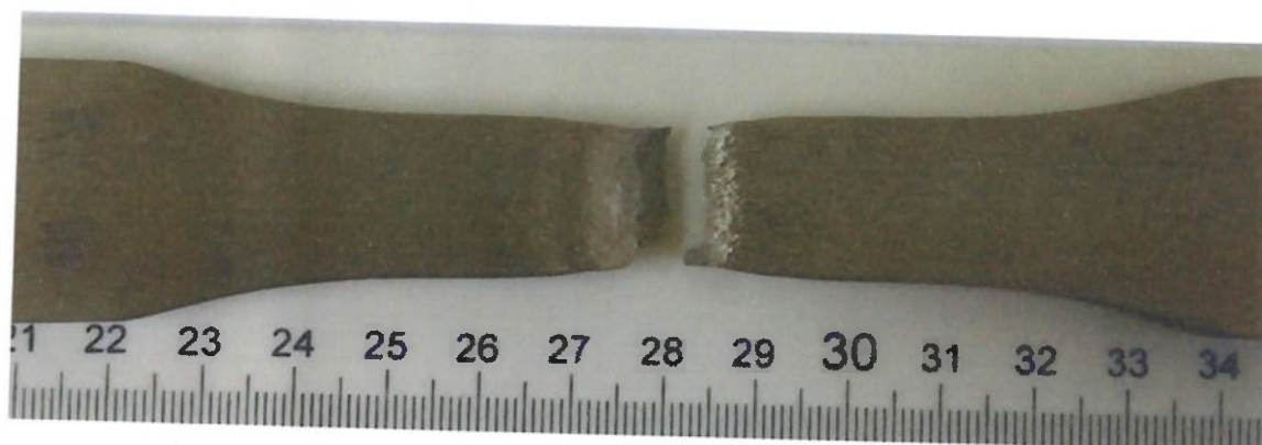
Figura 38: Amostra do ensaio de tração do CP4– Tração1
