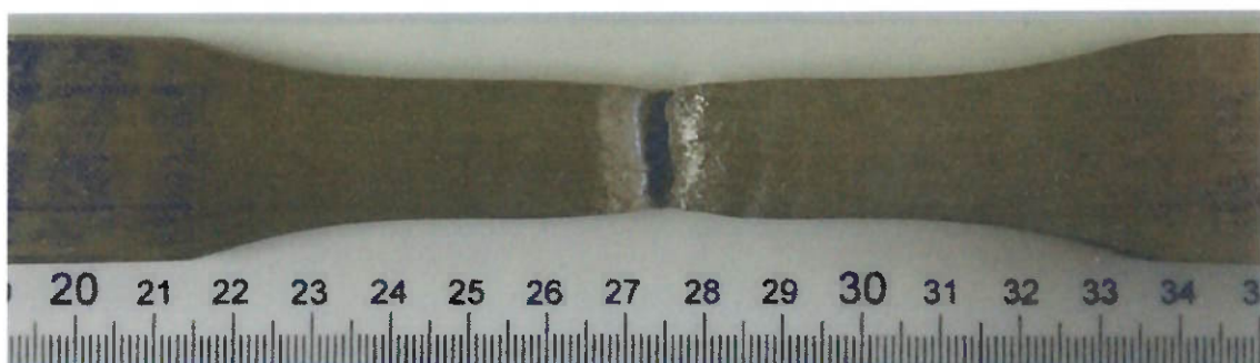
Figura 36: Amostra do ensaio de tração do CP3– Tração1
