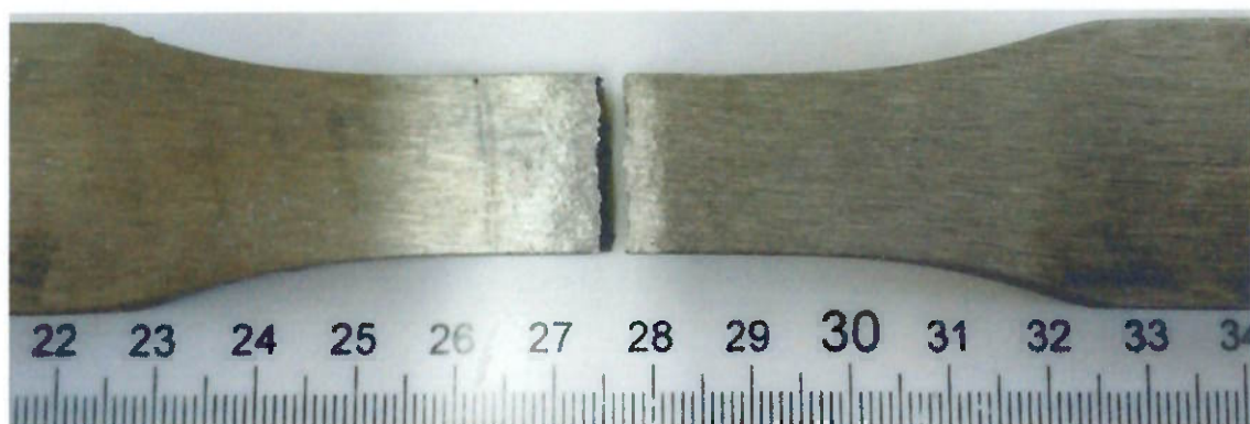
Figura 35: Ensaio de tração realizado no CP2 (Tração 2)
