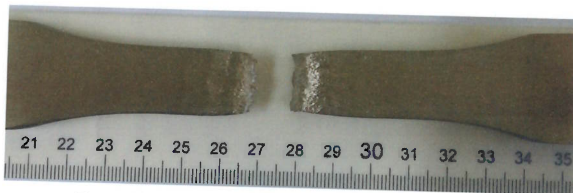
Figura 37: Amostra do ensaio de tração do CP3 – Tração 2
