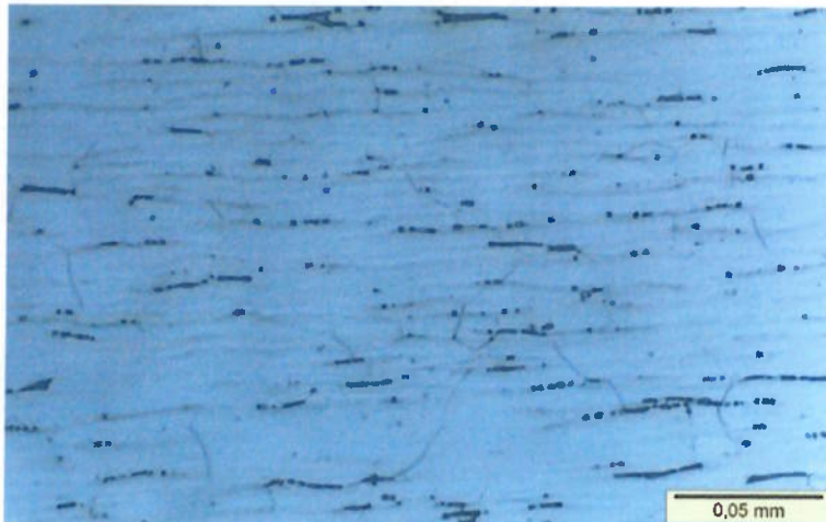
Figura 48: Análise Micrográfica no metal de base do CP2(500X)
