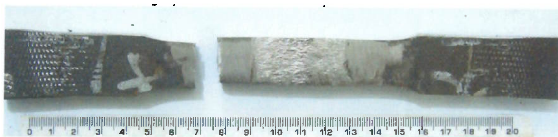
Figura 33: Ensaio de tração CP1 (Tração 2)
