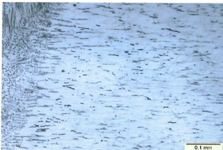
Figura 49: Análise Micrográfica na ZAC do CP2(500X)
