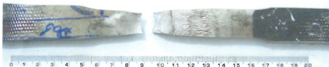
Figura 32: Ensaio de tração realizado no CP1 tração 1
