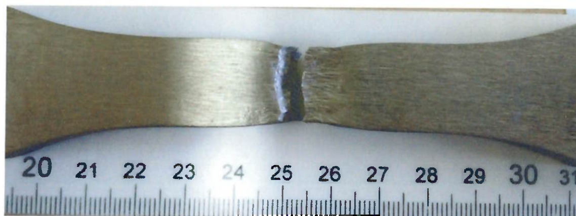
Figura 34: Ensaio de tração realizado no CP2 (Tração 1)
