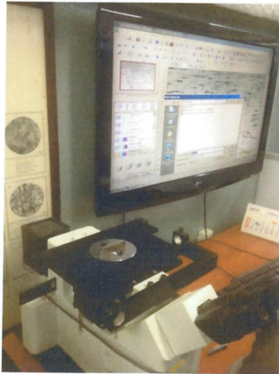
Figura 43: Microscópio óptico utiliza para análise micrográfica dos corpos de prova
