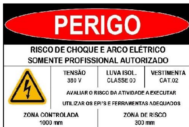
Figura 3: Distâncias de segurança para trabalhos elétricos em um CCM (Centro de Comando de Motores) Fonte: Empresa Diagnerg, 2013
