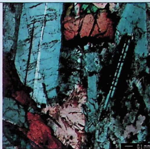
Fotomicrografia 10 - UC-RR-12 Dique de diabásio. Aspecto geral da disposição dos minerais. No centro relação entre augita e hornblenda. Nicóis cruzados. 5X.
