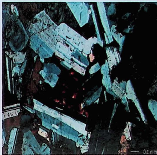
Fotomicrografia 2 - UC-RR-02 Soleira de diabásio. Aspecto geral da disposição dos minerais. No centro piroxênio augita. Nicóis cruzados. 5X.
