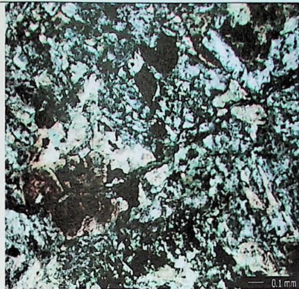
Fotomicrografia 13 - UC-RR-18b Dique de diabásio. Aspecto geral da disposição dos minerais. No centro relação entre augita e opacos. Nicóis paralelos. 5X.
