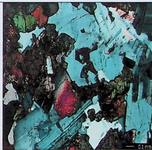
Fotomicrografia 8 - UC-RR-08 Dique de diabásio. Aspecto geral da disposição dos minerais. No centro relação entre augita e hornblenda. Nicóis cruzados. 5X.
