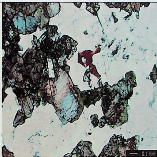
Fotomicrografia 7 - UC-RR-08 Dique de diabásio. Aspecto geral da disposição dos minerais. No centro relação entre augita e hornblenda. Nicóis paralelos. 5X.
