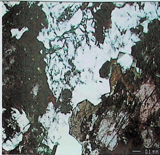
Fotomicrografia 5 - UC-RR-06 Dique de gabro. Aspecto geral da disposição dos minerais, no centro plagioclásios, augita e clorita. Nicóis paralelos. 5X.
