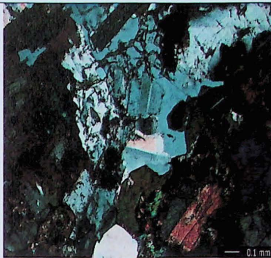
Fotomicrografia 6 - UC-RR-06 Dique de gabro. Aspecto geral da disposição dos minerais, no centro plagioclásios, augita e clorita. Nicóis cruzados. 5X.
