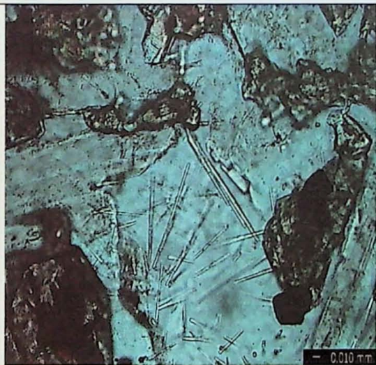
Fotomicrografia 3 - UC-RR-05 Soleira de diabásio. Apatita inclusa em cristais de plagioclásio. Nicóis paralelos. 40X.
