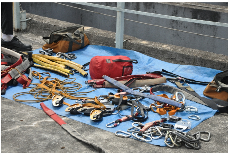
Figura 24: Equipamentos utilizados nos trabalhos em acesso por corda Fonte: Arquivo pessoal, 2012
