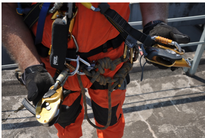
Figura 26: Profissional equipado para o trabalho em acesso por corda: trava-quedas e descensor
