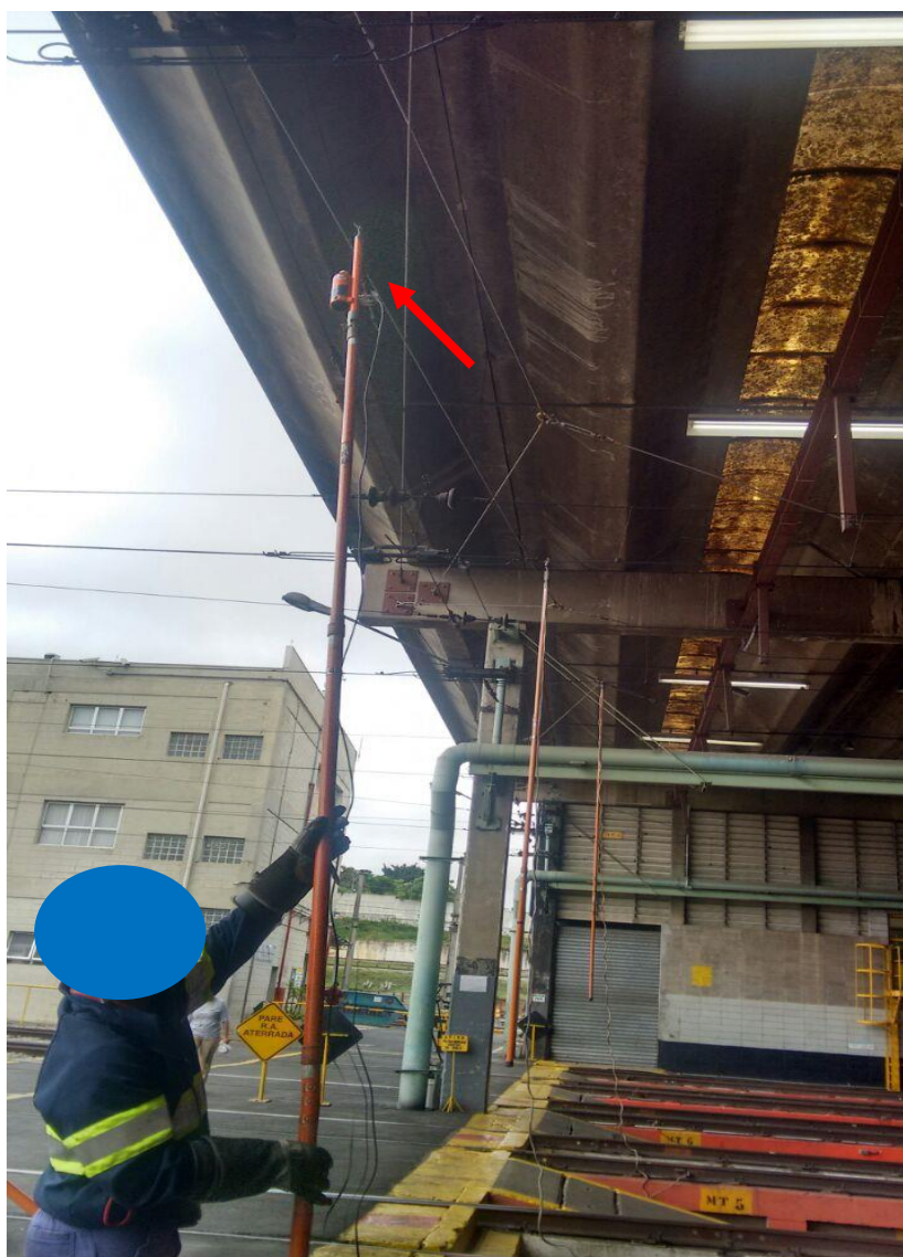
Figura 22 – Teste de Detecção de Tensão na Rede Aérea
