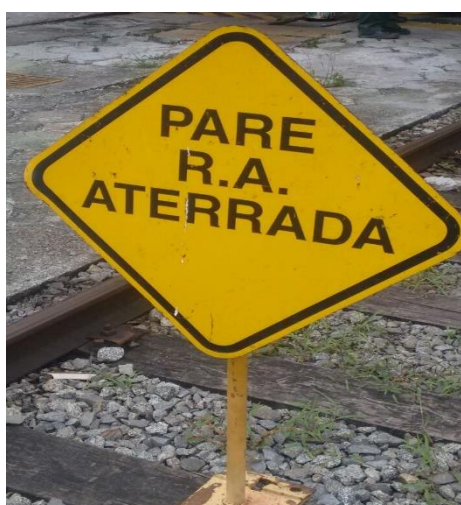
Figura 208 – Placa de sinalização “Pare R.A. Aterrada” = Pare Rede Aérea Aterrada
