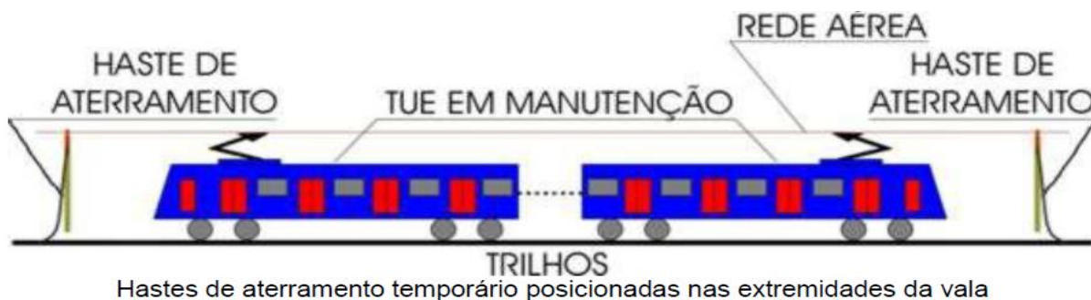
Figura 153 – Ilustração do Posicionamento dos Bastões de Aterramento nas duas Extremidades
