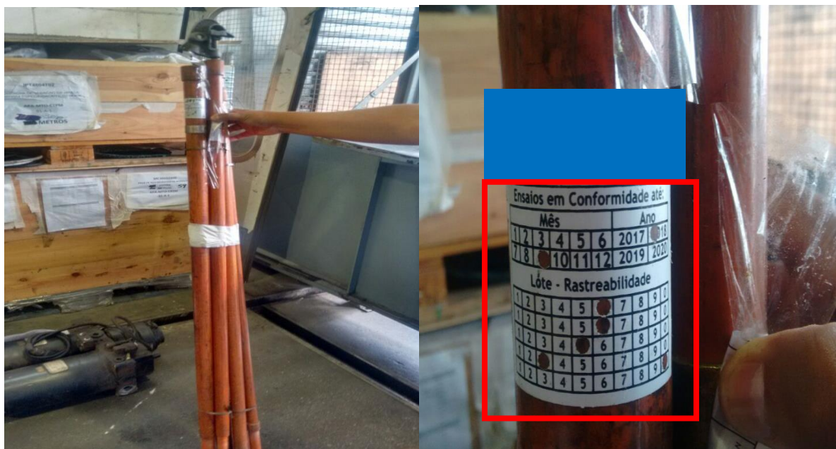
Figura 175 – Bastão de Aterramento e selo do teste de conformidade do bastão
