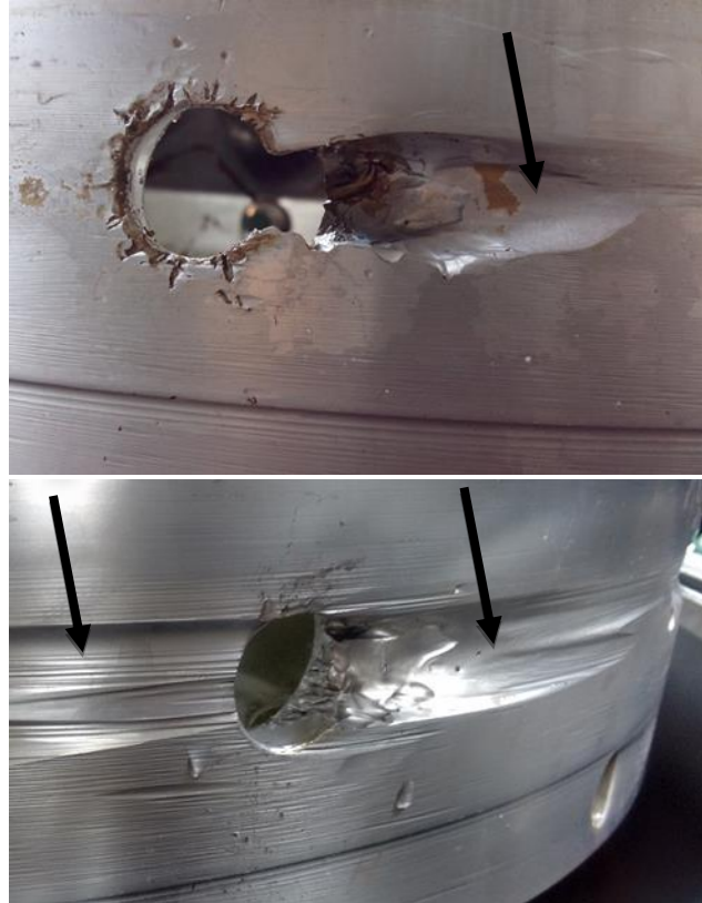
Figura 31 - Erosão no corpo do rotor da centrífuga.
