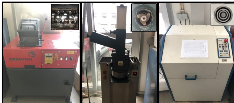
Figura 5 – Moinho de pré-moagem Erdwich (esq.); Moinho de lâminas Retsch SM 200 (cent.); Moinho de discos vibratórios Retsch RS1 (dir.). Nas figuras, há também, a representação interna do aparato de moagem.
