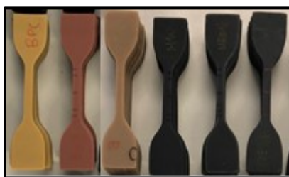
Figura 26 - Ilustração do efeito da inserção de pigmento em compósitos com couro escuro (três corpos de provas à direita) em comparação com inserção de pigmento em NBR (três corpos de provas à esquerda).
