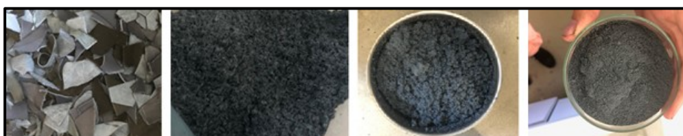
Figura 7 - Couro curtido a cromo cortado na guilhotina, couro pré moído no moinho de lâminas Erdwich, couro fibroso moído no moinho de lâminas Retsch SM 200, couro micronizado moído no moinho de anéis vibratórios Retsch RS1 (da esquerda para a direita).
