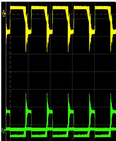
Figura 24 – Saída antes do retificador – (alimentação 127 Vca; 50V/div, 10us/div)
