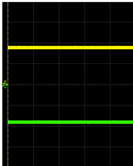
Figura 25 – Saída depois do retificador - (alimentação 127 Vca; 10V/div, 100us/div)
