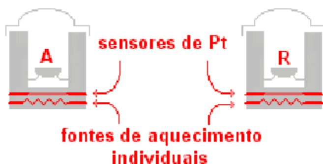
Figura 10- Esquema de um DSC por compensação de potência.
