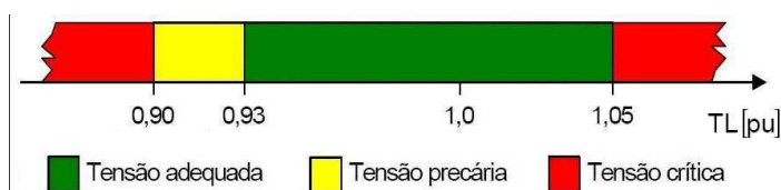
Figura 3.2 – Tensões nominais padronizadas entre 1 e 69 KV
