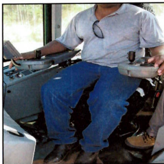
Figura 13 – Operador sentado com o acelerômetro fixado no banco
