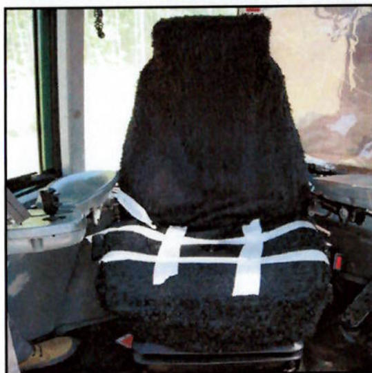
Figura 12 – Esquema de fixação do acelerômetro
