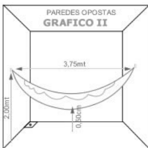
Figura 9.1. configuração para instalação da rede de descanso em paredes.
