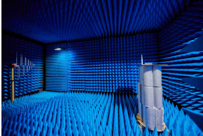
Figura 5 – Laboratório revestido com espuma anecoica para medições em radiofrequência.
