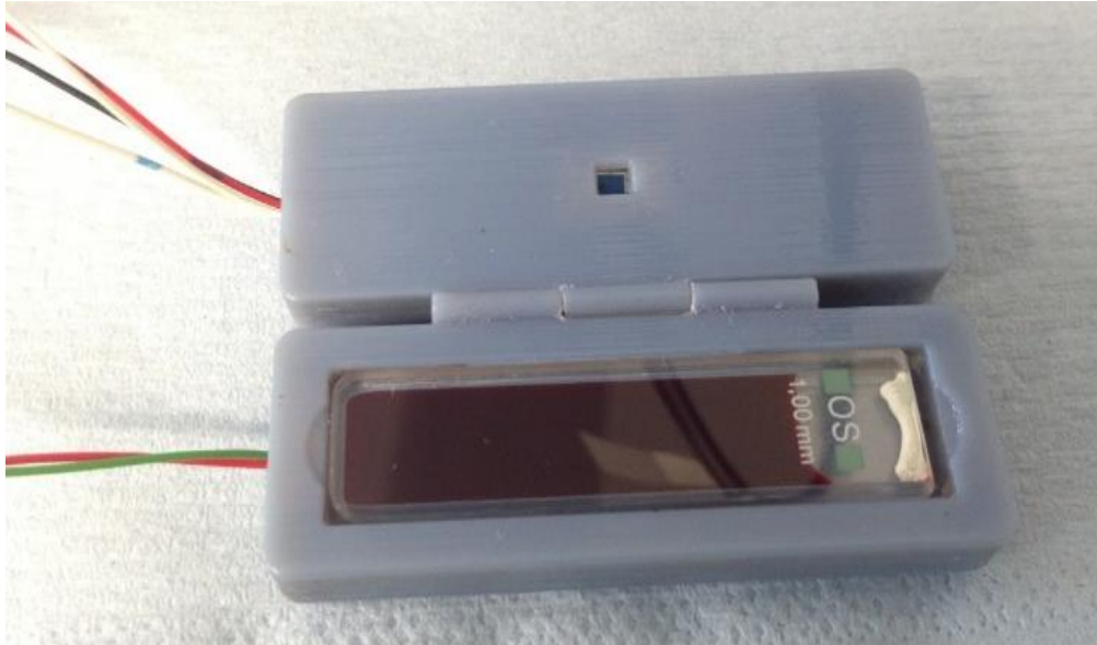
Figura 13 - Unidade articulada aberta com a cubeta posicionada (Fonte: Autoria própria)
