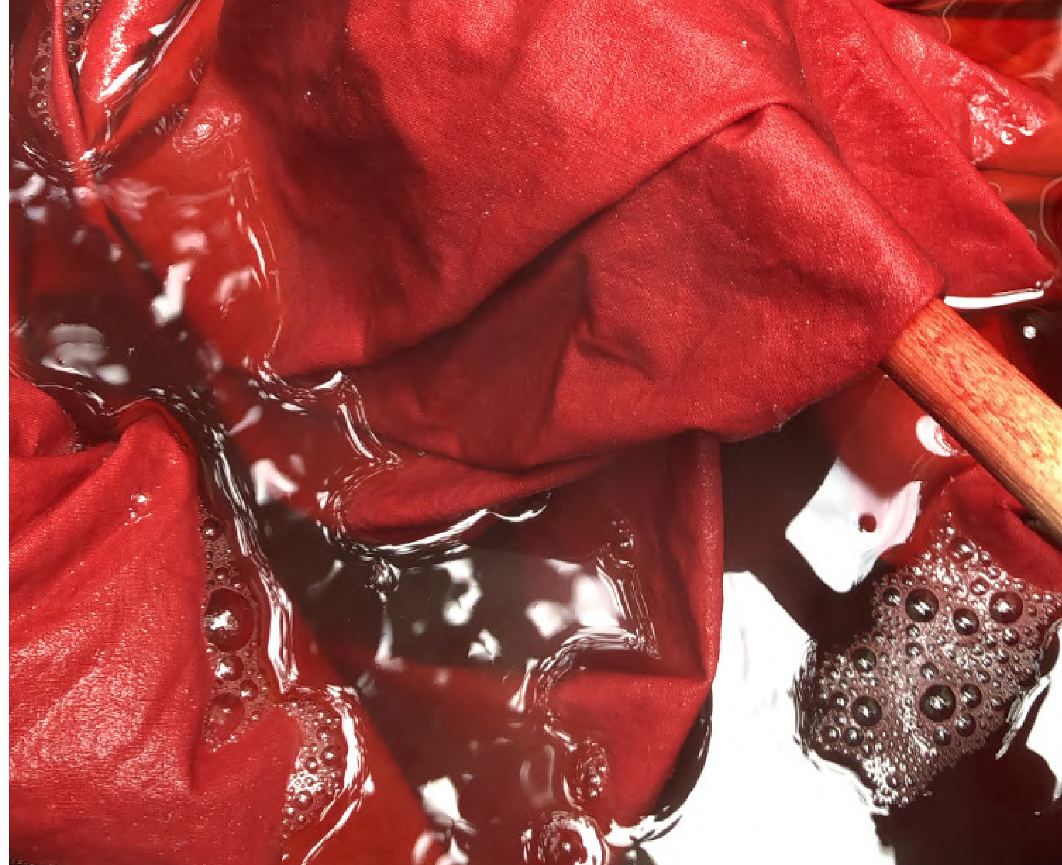
figura 50 - processo de tingimento de tecido de algodão com Pau-brasil
