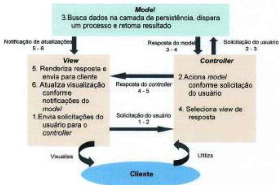
Figura 4 – Interação entre camadas do MVC
