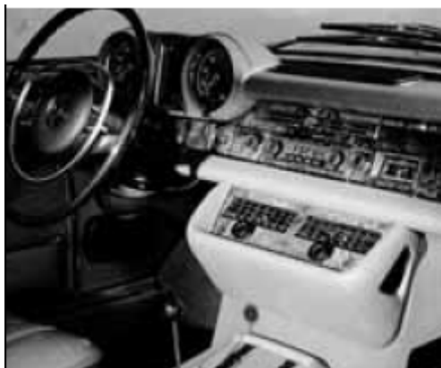
Figura 2 - O primeiro ar condicionado instalado em produção em série (Fonte: Facts and Figures 2006, arquivo institucional)
