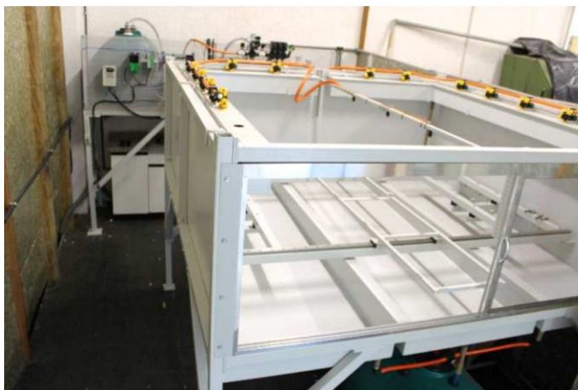
Figura 21 – Vista frontal da bancada de pulverização utilizada no trabalho. Ao fundo está o painel de componentes elétricos, eletrônicos e hidráulicos. Mais a frente pode-se ver a seção de barra com os bicos e pontas de pulverização. (Imagem cedida pelo Laboratório de Pulverização de Precisão Embrapa / LAC).
