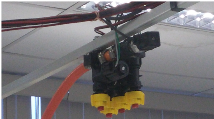
Figura 23 – Conjunto de válvulas QJS e bicos de pulverização ISO 110-04 utilizados no trabalho (Imagem cedida pelo Laboratório de Pulverização de Precisão Embrapa / LAC).
