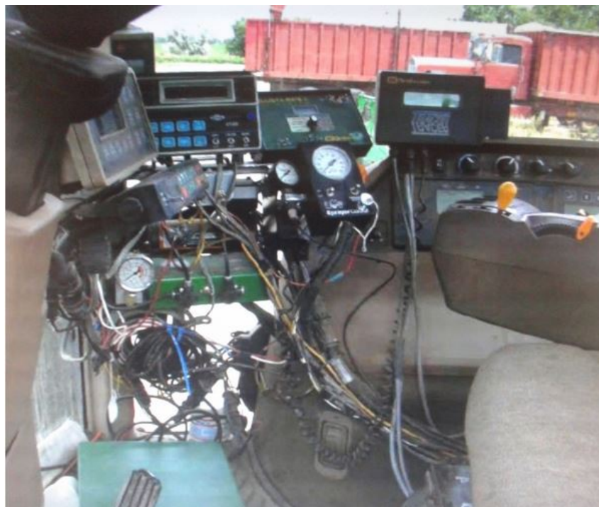
Figura 1 – Quantidade excessiva de fiação na cabine de um trator em virtude dos inúmeros equipamentos instalados. Fonte: Nissen (2008) .
