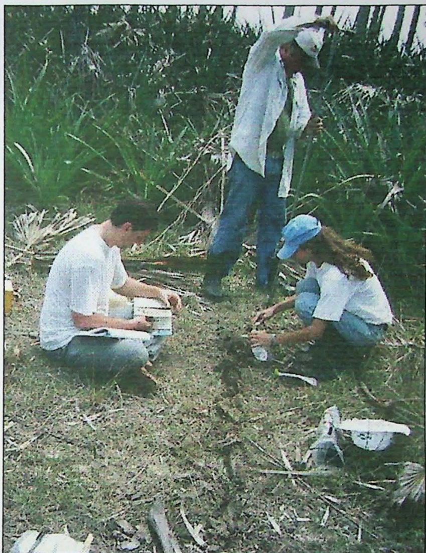
Foto 05. Procedimento de coleta de água de subsuperfície, utilizando trado.
