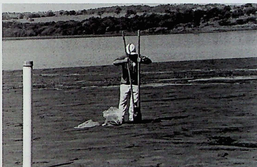
Figura 5.2a – Coleta de rejeito na barragem de rejeito com uso de ferramenta manual e embalado em sacos plásticos.
