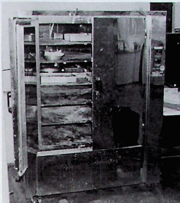
Figura 5.3a – Estufa utilizada para a retirada da umidade do rejeito.
