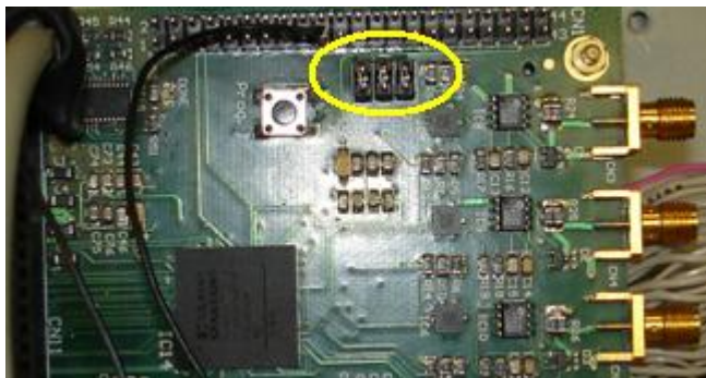
Figura 15: Detalhe mostrando posição dos jumpers na placa.
