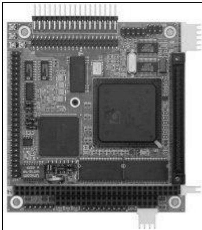
Figura 11: Configuração típica de módulo de CPU no formato PC-104; Fonte: [5].
