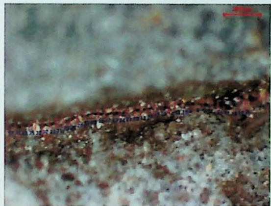
Foto- 7b - psi 1, abertura média de 53,1 \times 10^{-6} m
