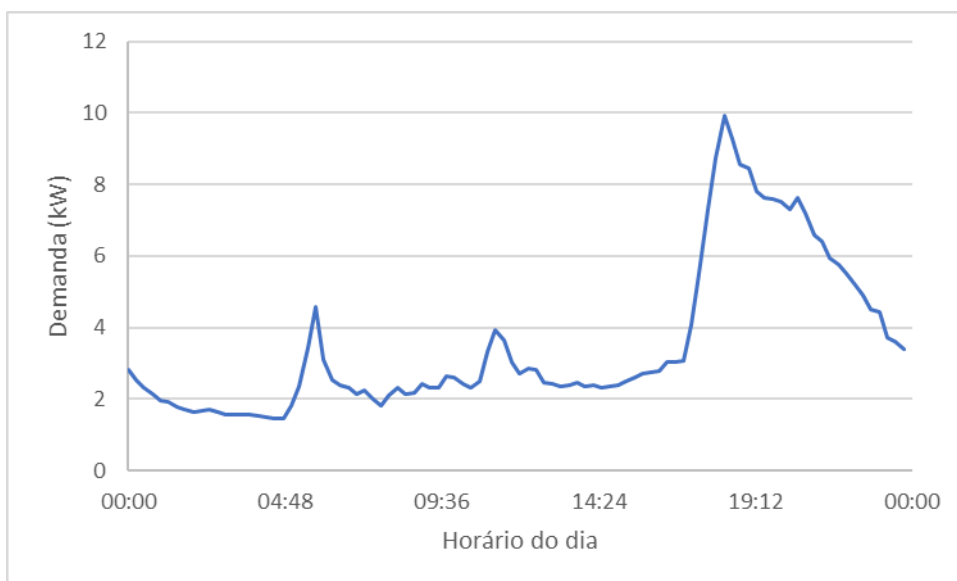
Figura 13 – Curva de carga diária de um transformador
