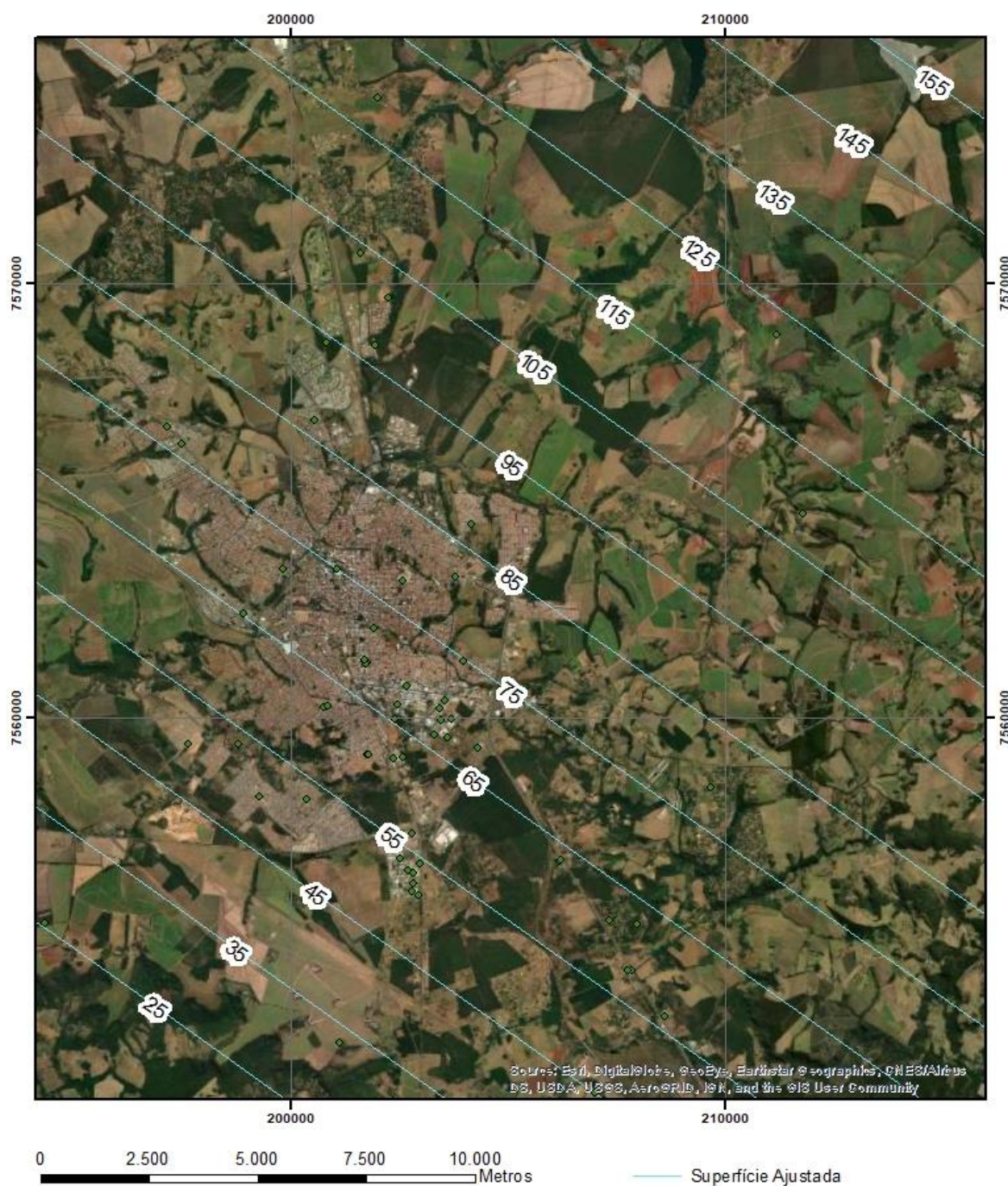
Figura 10 - Superfície polinomial de grau 1 ajustada aos dados de carga hidráulica.
