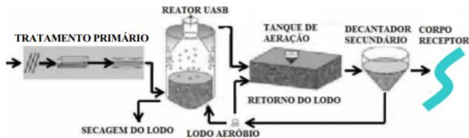
Figura 8 – Esquema de reator UASB procedido por lodos ativados.
