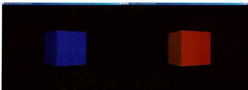
Figura 5-3: Aplicação de dois fragment shaders, um para a cor azul e outro para a cor vermelha do anaglifo
