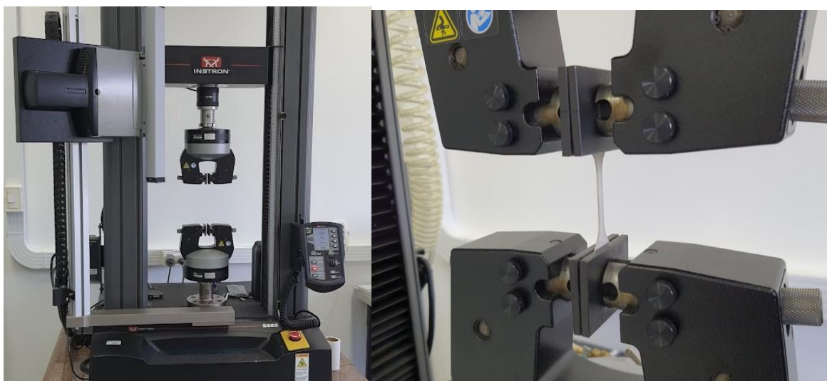
Figura 13 (a) à esquerda: Equipamento Instron 5969 Universal Material Testing Machine com garras para ensaio de tração, (b) à direita: célula de carga com corpo de prova pronto para realização do ensaio.
