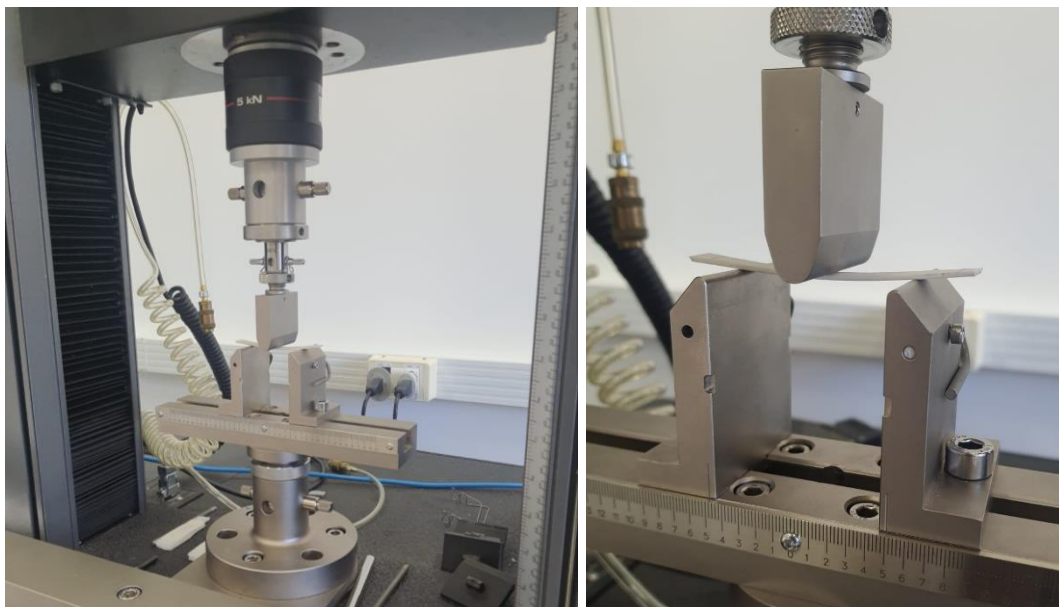
Figura 15 (a) à esquerda: Equipamento Instron 5969 Universal Material Testing Machine com suporte para ensaio de flexão, (b) à direita: célula de carga com corpo de prova pronto para realização do ensaio
