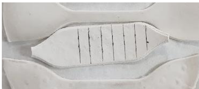
Figura 14 – corpo de prova para ensaio de flamabilidade com marcações para avaliar o avanço da chama
