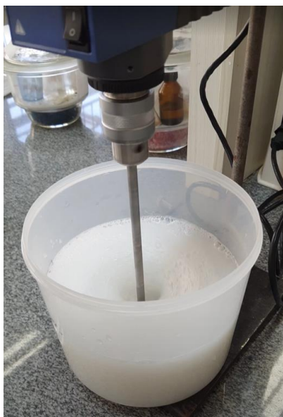
Figura 9 – Etapa de mistura do agente precipitador com agitador mecânico
