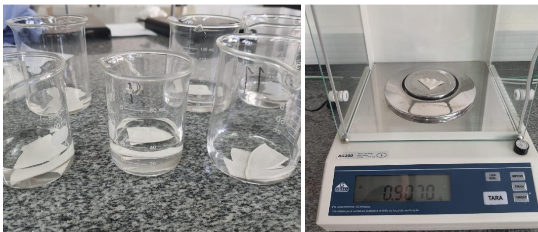
Figura 16 (a) à esquerda: Amostras em imersão, (b) à direita: pesagem de amostra com balança de precisão
