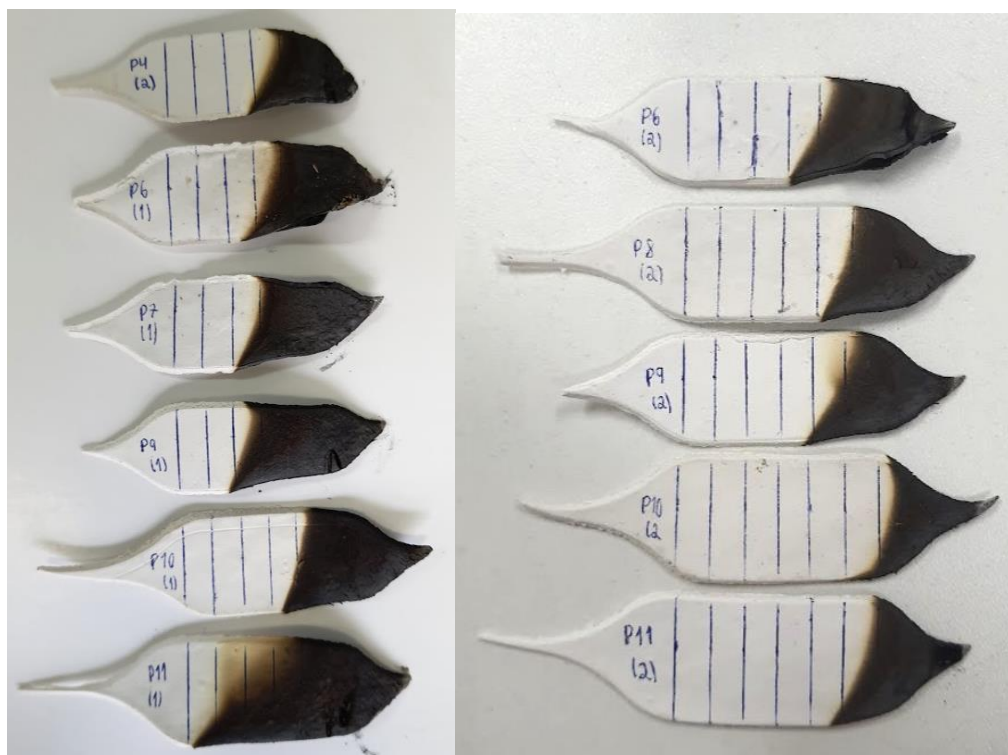
Figura 23 – Comparação dos danos dos corpos de prova submetidos a ensaio de flamabilidade
