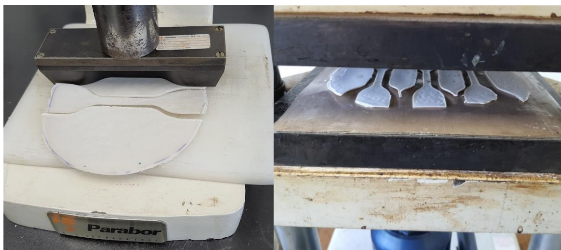
Figura 12 (a) à esquerda: Corte dos corpos de prova com auxílio da lâmina molde (b) à direita: Prensagem à quente para planificar os corpos obtidos
