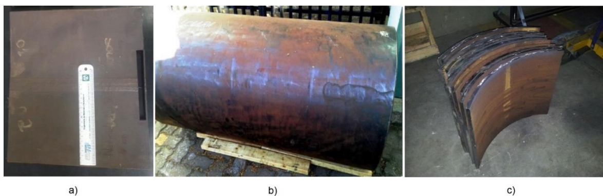
Figura 16 – a) Chapa de material normal nióbio b) tubo conformado por solda helicoidal com material alto nióbio c) chapas feitas com o tubo de alto nióbio.
