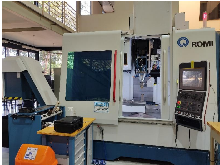
Figura 5 - Máquina de manufatura híbrida utilizada para realizar as deposições
