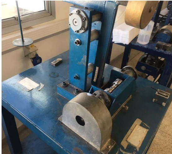
Figura 8 - Equipamento utilizado para a realização dos ensaios de desgastes microadesivos.
