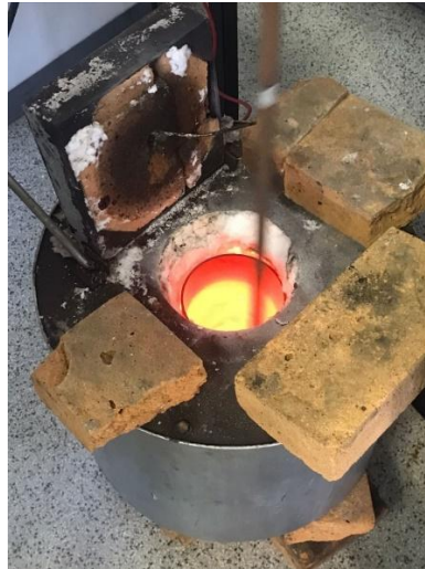
Figura 7 - Forno do tipo “poço” e controlador de temperatura utilizados para a realização do tratamento de boretação
