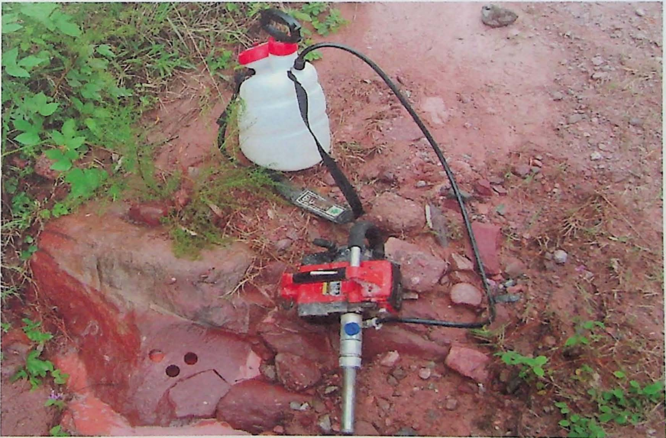
Figura 1: Aspecto da perfuratriz utilizada para obtenção das amostras. Notar os furos resultantes da retirada das amostras (P36 – Grupo Santa Bárbara).
