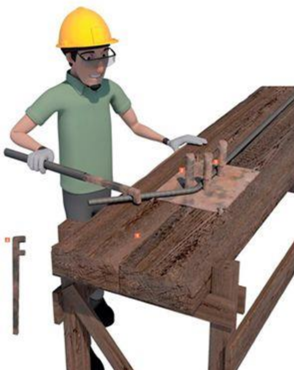
Figura 23 - Bancada com pinos e chave de dobra
