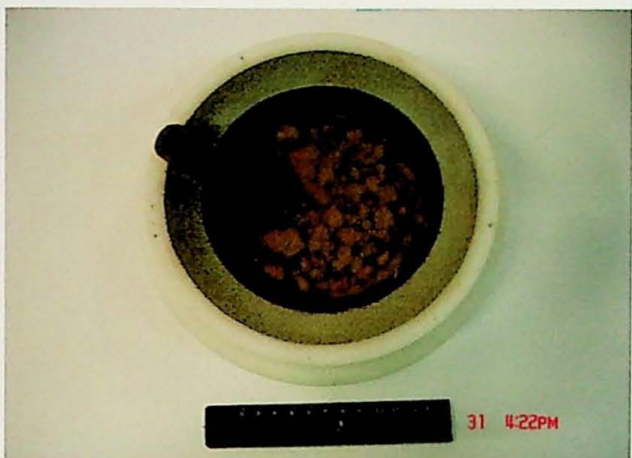
Figura A: Destorroamento de amostra em almofariz de ágata.
