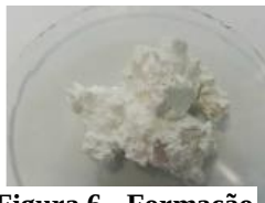
Figura 6 - Formação de precipitado branco granulado de cloreto de prata.
