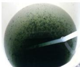
Figura 8 – Precipitado esverdeado de Hidróxido de cromo III
