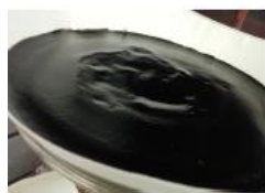
Figura 7 - Formação de precipitado preto de sulfeto de mercúrio II e mercúrio metálico.
