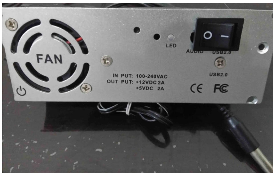
Figura 24 – Fonte de alimentação com saídas 5VDC e 12VDC.
