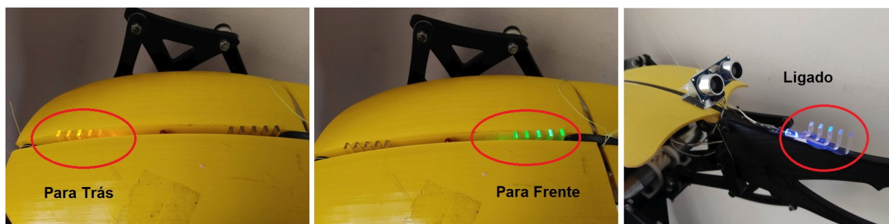
Figura 41 – LEDs indicadores de direção e On/Off .
