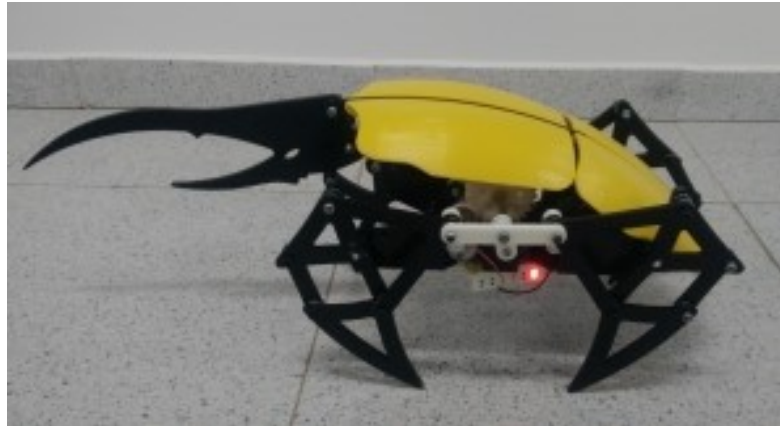
Figura 14 – Primeira versão impressa da montagem do mecanismo.
