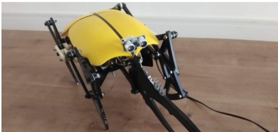
Figura 39 – Detalhe do sensor de obstáculo HC-SR04.
