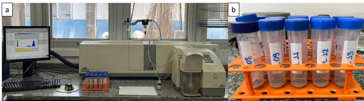
Figura 7 - a) Análises granulométricas realizadas no granulômetro Malvern Mastersizer 2000 com Hydro 2000MU. b) Amostras em tubo Falcon de 50 mL submetidas ao tratamento prévio à análise granulométrica.
