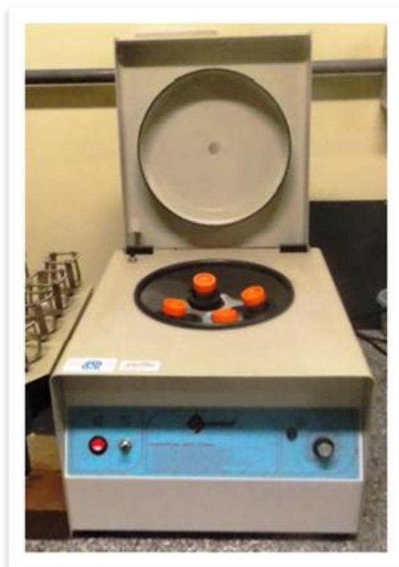
Figura 20 - Centrífuga tubos QUIMIS para separação das fases (extraído de Silva, 2013).
