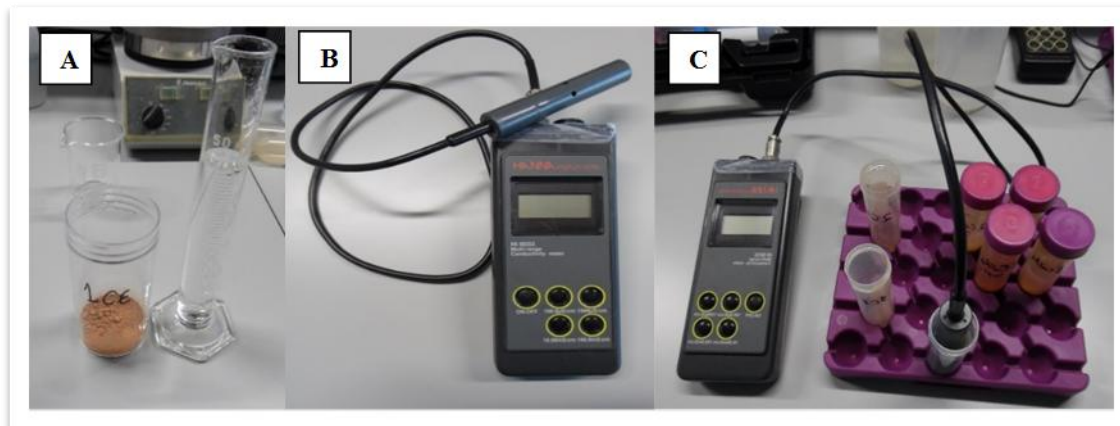
Figura 10 - Da esquerda para a direita: A) Mistura de água destilada e material inconsolidado; B) Condutivímetro Hanna HI 9033; C) Medição da condutividade elétrica das amostras.
