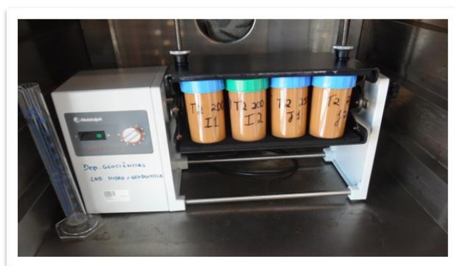
Figura 26 - Agitador Orbital de rotação empregado para agitação dos extratos solo-solução.
