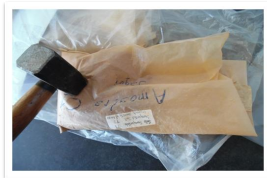
Figura 7 - Destorroamento da amostra de material inconsolidado.
