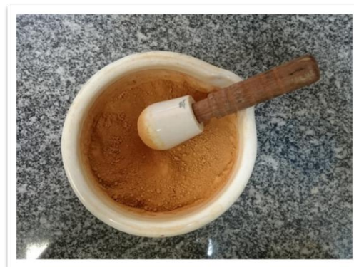
Figura 8 - Destorroamento do material inconsolidado.
