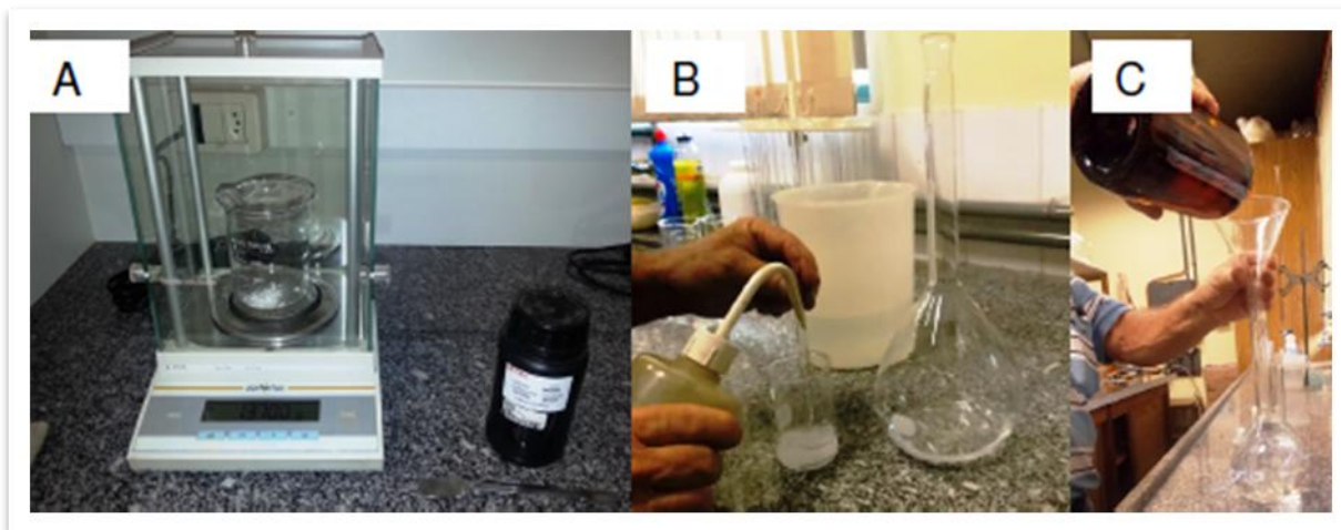
Figura 14 - Preparação das solução-mãe utilizada no ensaio de equilíbrio em lote. A) Medição da massa do sal; B). Dissolução do sal em água destilada; C) Diluição da solução em 1L (extraído de Silva, 2013).
