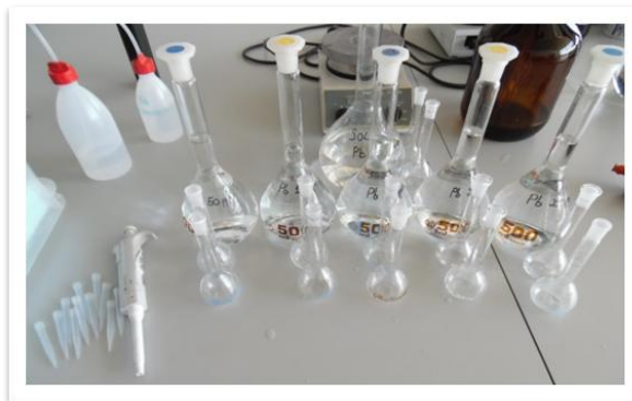
Figura 31 - Diluição das amostras para medição da concentração de Pb/Zn por Absorção Atômica.
