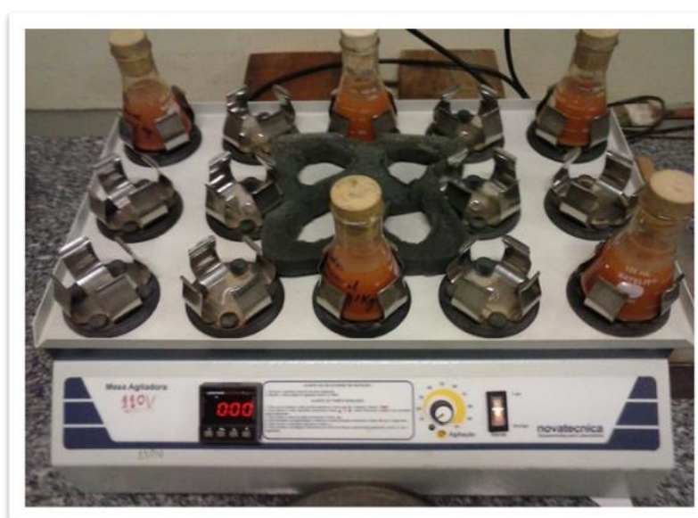
Figura 18 - Mesa agitadora empregada para agitação dos extratos solo/solução.
