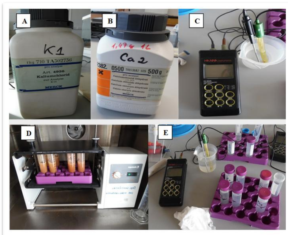
Figura 9 - Da esquerda para a direita: A) Sal cloreto de potássio; B) Sal cloreto de cálcio; C) pHmetro Hanna modelo HI9025; D) Agitador orbital modelo Reax 2®; E) Medição do pH das amostras.
