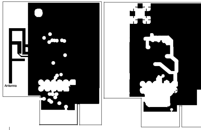
Figura 6.1.2 – Plano PCB superior e inferior da antena Microchip [13].
