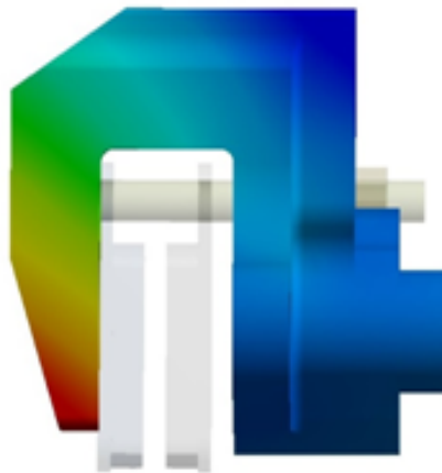
Figura 1.2: Disco de freio simulado pelo Ansys , de autoria da extracurricular BAJA-EESC
