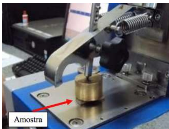
Figura 11: Amostra posicionada no aparelho ICP para ensaio de composição química
