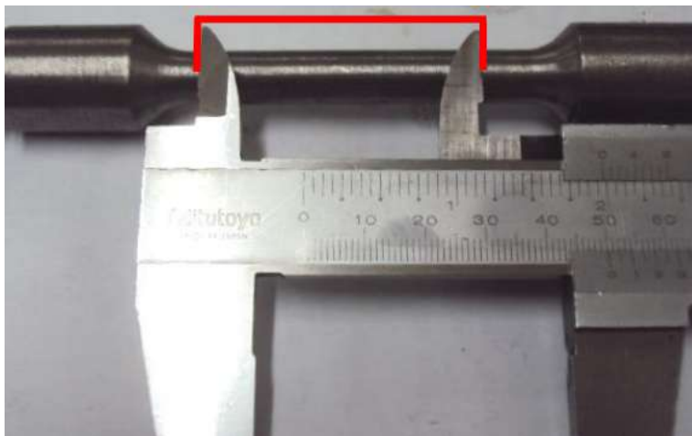
Figura 13: Determinação do comprimento útil para análise de deformação
