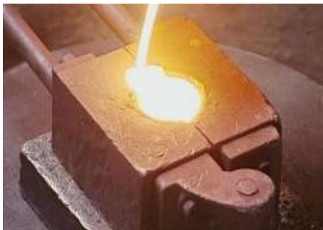
Figura 10: Coquilha refrigerada para obtenção de amostras para análise química
