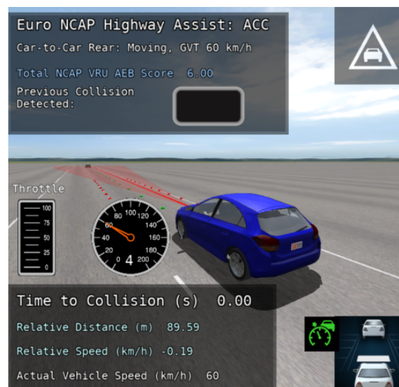
Figura 49: Teste CCRm - GVT @ 60 km/h: Representação gráfica do teste no CarSim
