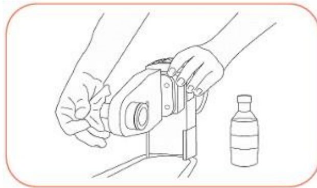
Figura 15: Fixação termofusão e limpeza do bocal de aquecimento.
