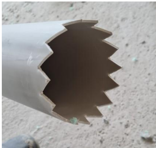
Figura 83: Tubo preparado para furar passante em espuma.
