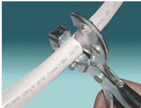
Figura 23: Corte perpendicular com tesoura específica.
