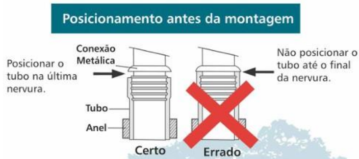
Figura 27: Detalhe de posicionamento entre tubo e conexão.
