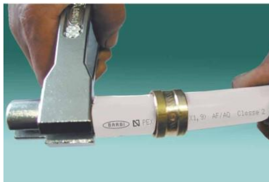
Figura 25: Ajuste da extremidade do tubo com alargador.
