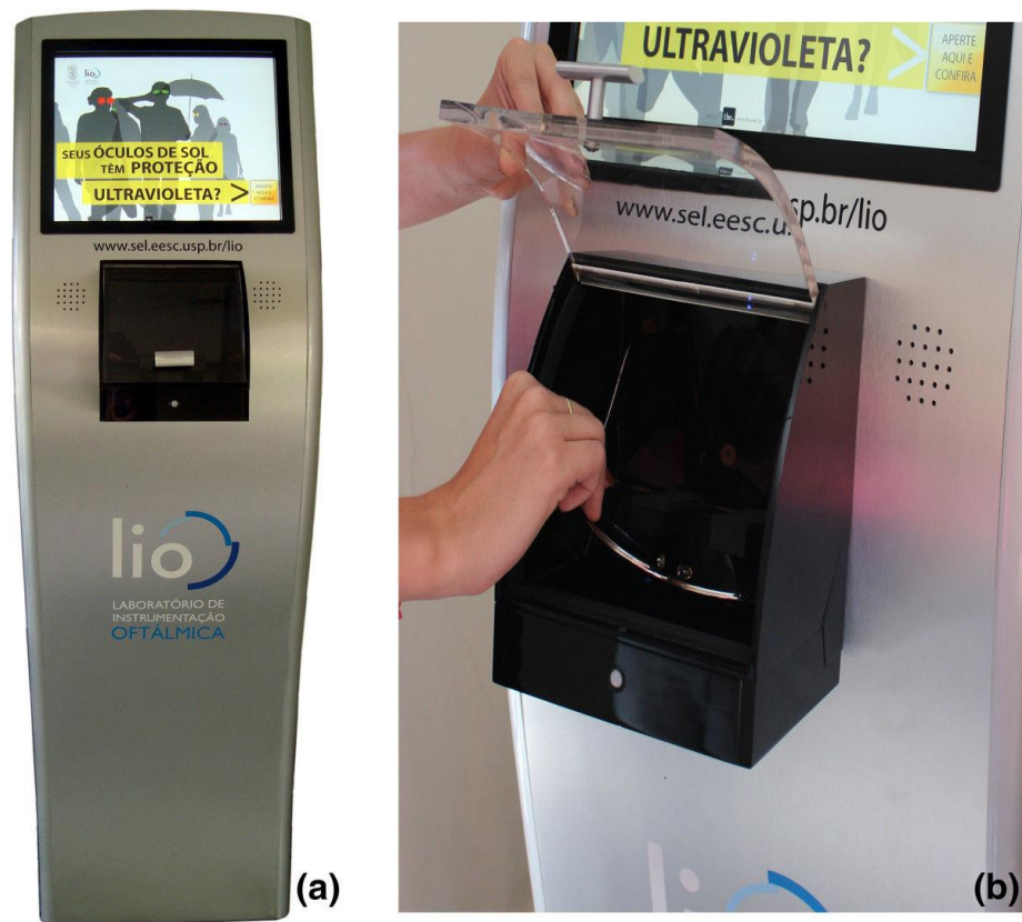
Figura 15: Totem de medição desenvolvido no LIO para medição de transmitância luminosa e Ultravioleta de óculos de sol
