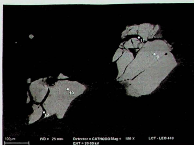
Foto 20 - Amostra: 2, -0,30+0,21mm. Mesmo grão da foto anterior visto em CL, evidenciando variações composicionais.
