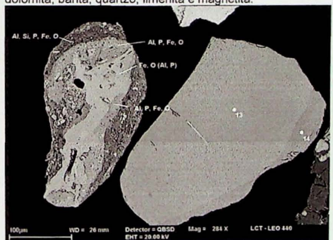
Foto 23 - Amostra: 3, -0,30+0,21mm. Grão de apatita com superfície límpida e variação composicional e aglomerado de alumino-fosfatos com variações composicionais apresentando (Fe, O, Al, P e Si).
