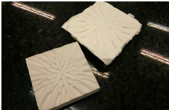
Figura 44: Molde de gesso à esquerda e polpa de papel filtro conformada sobre o contramolde à direita
