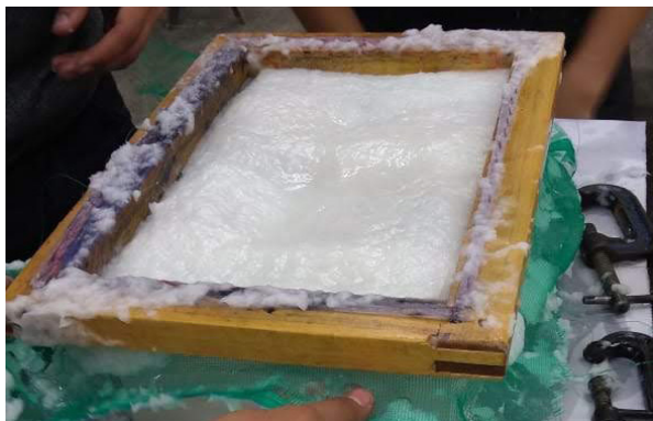
Figura 59: Transferência da polpa para o molde
