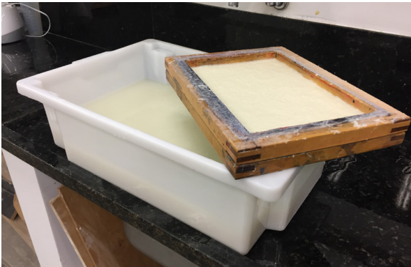
Figura 38: Bastidores escorrendo o excesso de água
