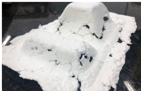
Figura 63: Peça que grudou no molde pela falta da tela
