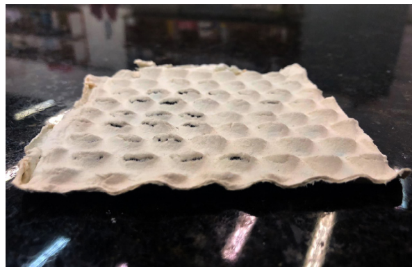
Figura 46: Rompimento da polpa na moldagem dos cantos vivos
