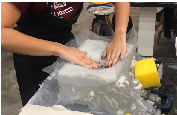
Figura 80: Telas e esponja ajudam na conformação da peça
