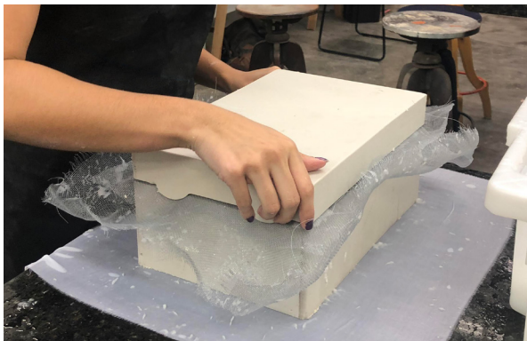
Figura 81: Fechamento dos moldes com telas dos dois lados
