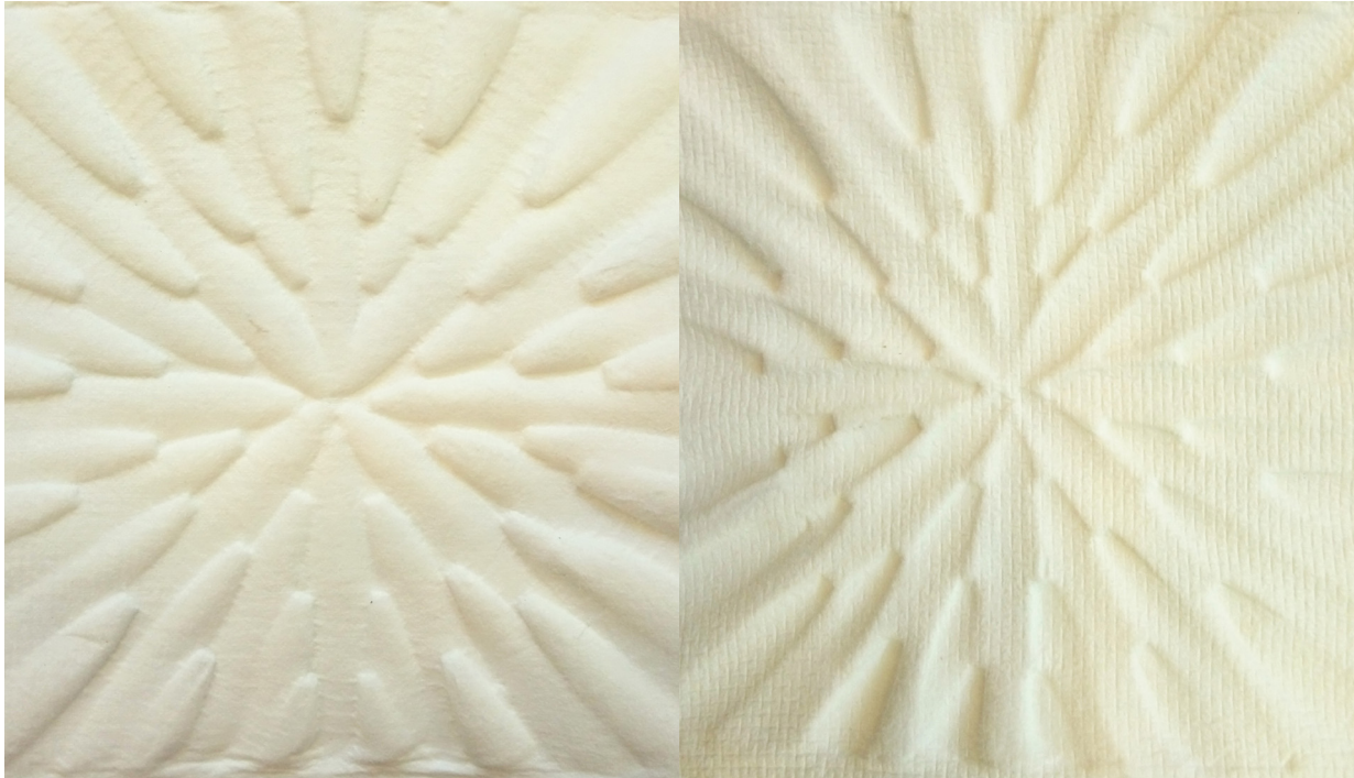
Figura 47: Frente e verso da polpa de papel filtro moldada. O da direita ganhou essa textura por ficar em contato com a tela mosquiteira na hora da produção do papel
