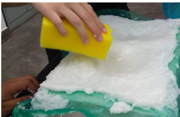
Figura 61: Absorção do excesso de água
