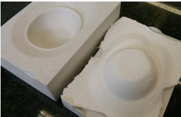
Figura 84: Moldes de gesso do recipiente e este conformado
