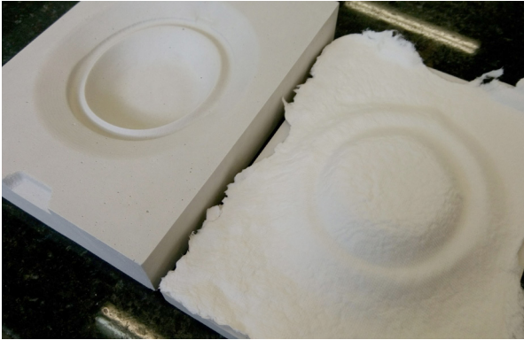
Figura 82: Moldes de gesso da tampa e esta conformada
