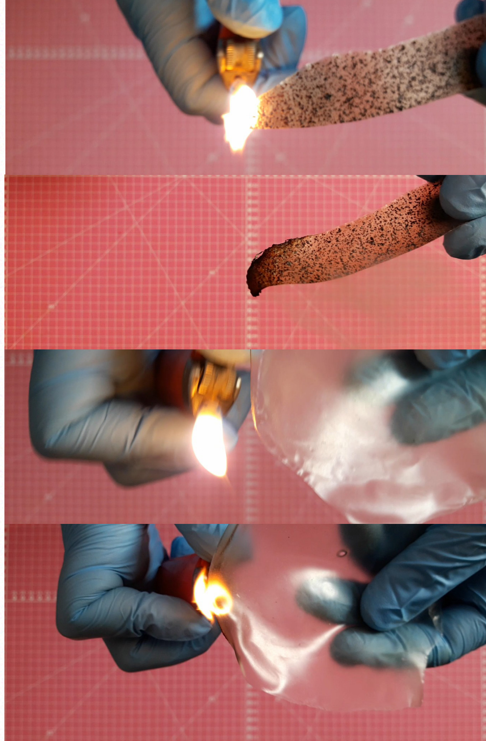
Figuras 63 - 66: Testes de inflamabilidade
