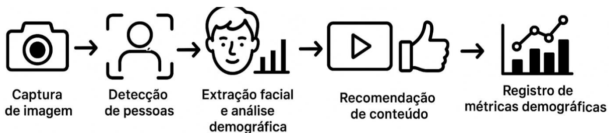
Figura 5 – Pipeline utilizada na solução
