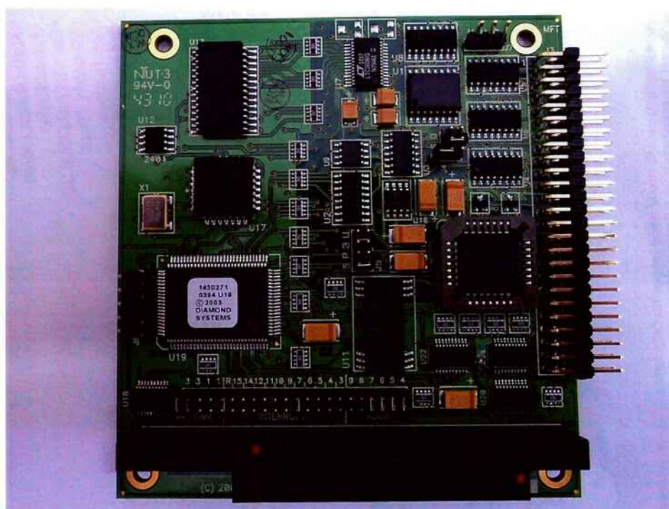
Figura 38 - Foto da placa de aquisição DIAMOND-MM-16-AT
