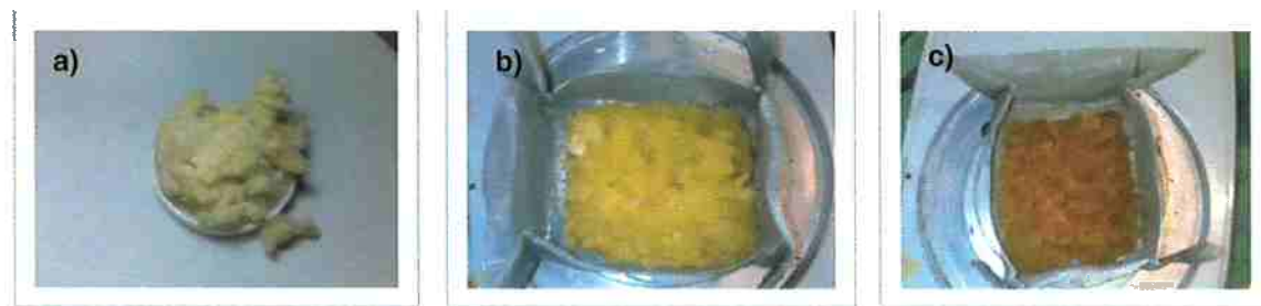
Figura 24 - Absorção de óleo por um grama de Bioespuma: a) Bioespuma seca; b) Resultado da Bioespuma em solução de água e óleo; c) Resultado do material depois de 20 horas na estufa(120°C)
