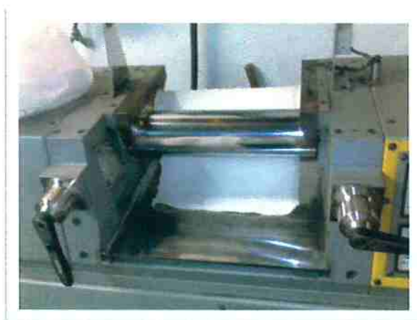
Figura 17 - Manta de Polpa na Calandra Térmica
