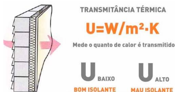
Figura 2.3 – Ilustração e fórmula da transmitância térmica. Fonte: (CA2, 2019).
