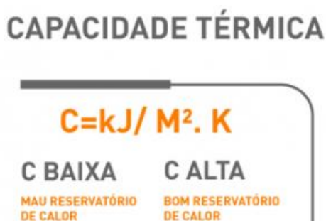
Figura 2.7 – Ilustração e fórmula da capacidade térmica. Fonte: (CA2, 2019)
